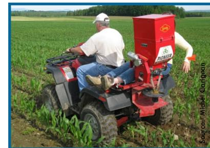
Des semoirs munis de tubes de descente avec cuillères ont été utilisés. Il a ainsi été possible de réaliser un semis plus concentré dans les entre-rangs. De plus, elle offre une protection contre le vent, contrairement aux semis à la volée par épandeur d'engrais.
