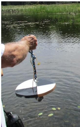
Figure 6 : Disque de Secchi
