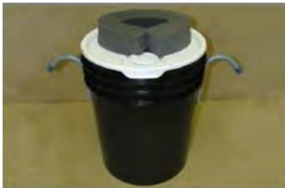
Figure 10 : L'aquascope est un appareil d'une lentille translucide (plexiglas) permettant d'observer le fond de l'eau sans l'effet réfléchissant de la lumière à la surface de l'eau (MELCC, 2016)
