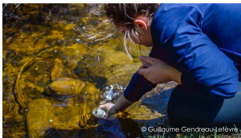
Figure 5 : Prise d'échantillon pour mesurer la teneur en coliformes fécaux d'un tributaire
